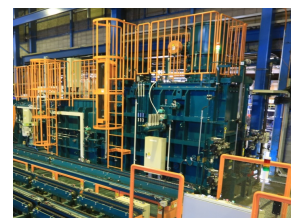
図 1.最新型真空浸炭炉
