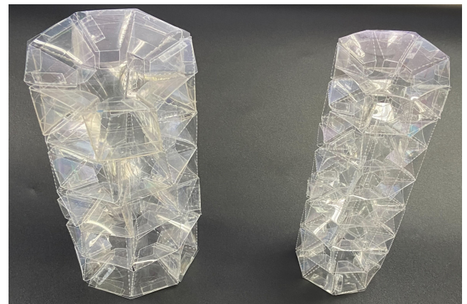
図 17: 異なる高さや太さの Twisted Tower (左: 太さ 90mm 高さ 170mm (5層), 右: 太さ 64mm 高さ 168mm (7層))
