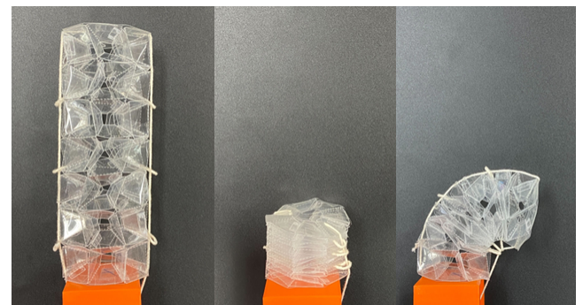
図 18: Twisted Tower の駆動 (左: 通常状態, 中央: 収縮状態, 右: 曲げ状態)
