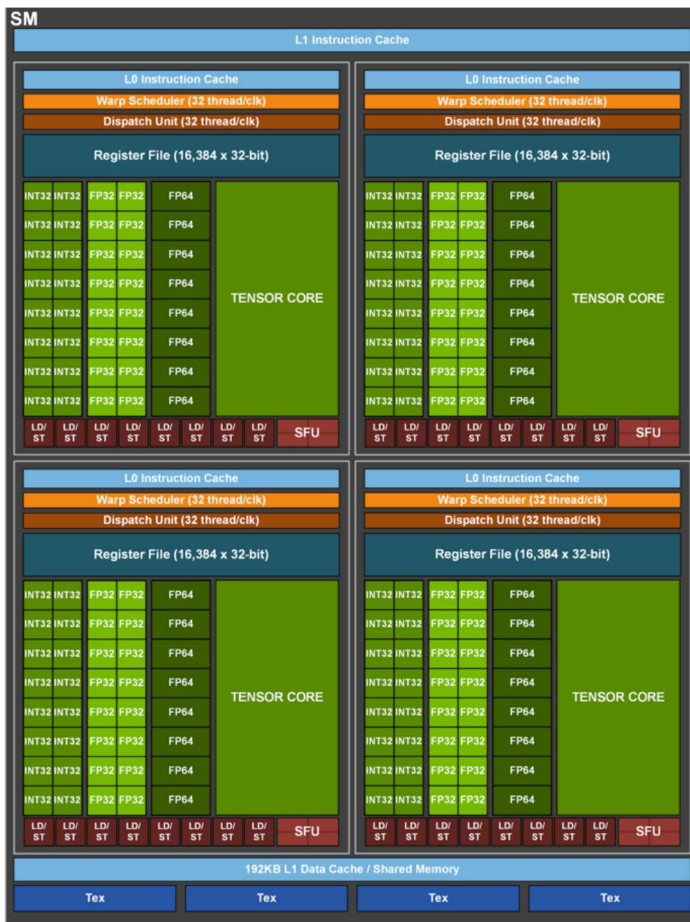
図 2.2: NVIDIA A100 GPU の SM あたりのアーキテクチャ(文献 [10] から引用)
