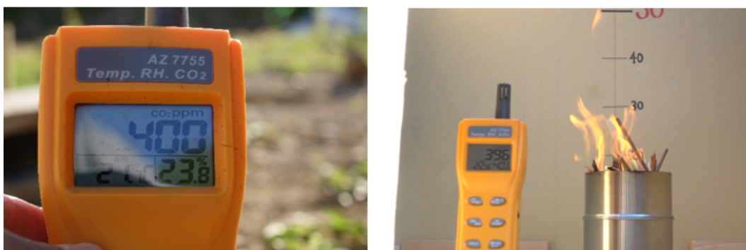
図 4.3: 測定器 (AZ 7755)(左)と設置状況(右)
