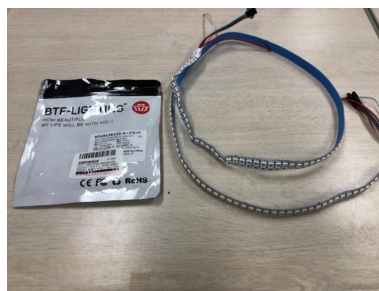
図 5.5: 使用したLEDテープ (WS2812B)
