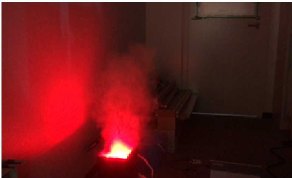
図 5.8: 疑似炎発生ユニット作動状況
