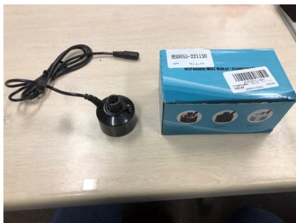
図 5.2: 使用した超音波噴霧器の外観
