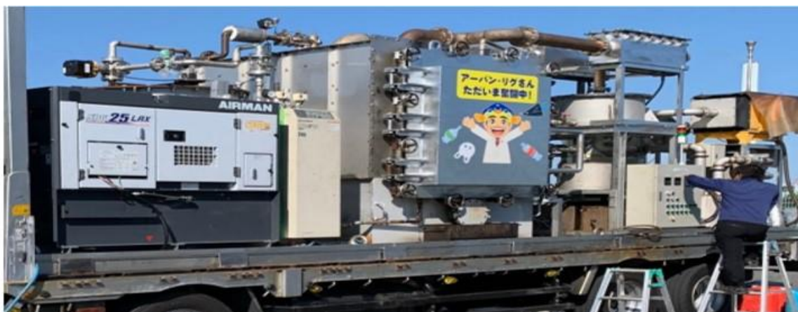
図5 小型水蒸気熱分解による再生資源燃料抽出装置（日本財団イノベーション賞受賞）
