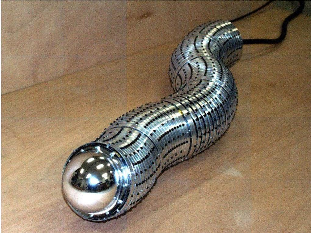
図 2.3: スライムロボットの写真
