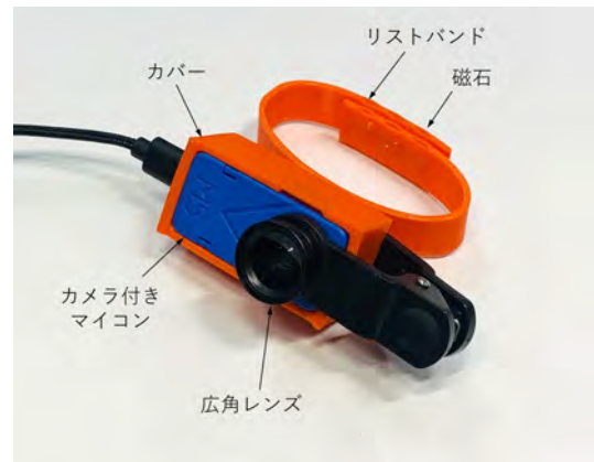
図 3: 手首装着型カメラデバイスの概略図 Fig. 3 Overview of the wristband device with a camera.
