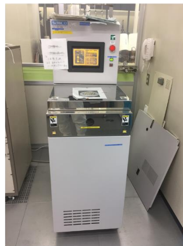
図 2-2 RIE の概略図 (左) と外観 (右)
