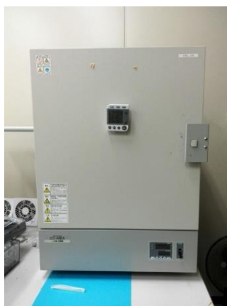
図 2-12 アニール炉の外観
