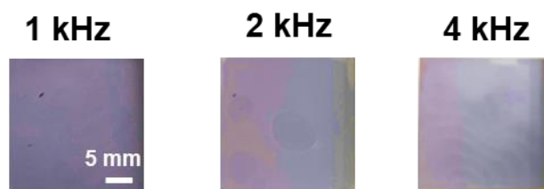
図 C2 サブパルス周期を変化させた FLA 後の p-poly-Si の表面写真
