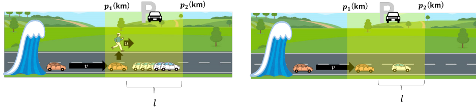
図 4.4: \lambda のイメージ図. 左は前方の車両数が多いため乗り捨てやすい様子を, 右は前方の車両が少ないため乗り捨てにくい様子を表している. オレンジが目している車両であり, 前方とはオレンジの車両から l km 先の区間を表している. (著者作成.)
