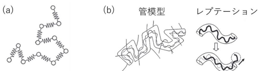
Figure 3-3. (a)ラウズ緩和モデル, (b)レプテーション緩和モデルとレプテーション運動<sup>4)</sup>
