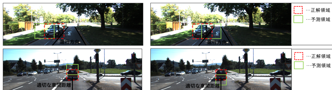
図 1.1: IoU を用いた評価では安全性が不十分になる例
