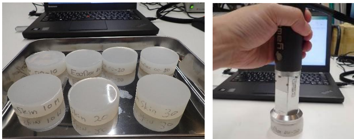
図 14：硬度サンプル用試料と弾性測定装置 YAWASA YWS-50N
