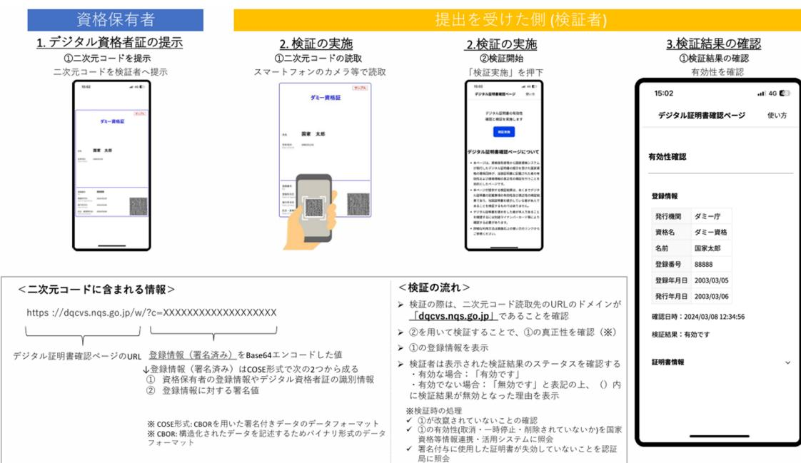
図 2 デジタル証明書の検証の仕組み
