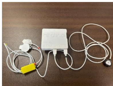
図 3-7 BITalino コアと EDA・PUL センサ
