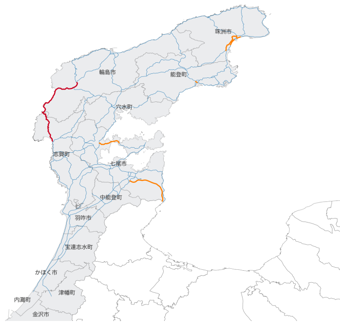
図 5.8: 緊急輸送道路と実災害での斜面崩壊・堆積分布の重なりによる寸断判定結果
