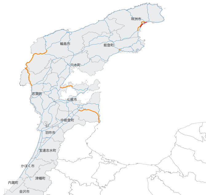
図 5.9: 緊急輸送道路と実災害での津波浸水域の重なりによる寸断判定結果
