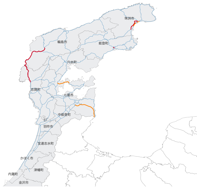
図 5.4: 緊急輸送道路と土砂災害ハザードマップの重なりによる寸断判定結果
