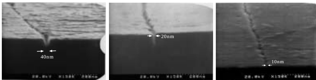
図 2 ナノトレんチの断面 SEM 像
