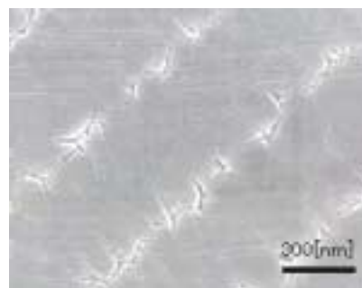
Fig.2 レーザー照射部の SEM 像
