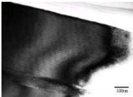
図 1 MQW 試料の As/Ga フラックス比が高い部分の断面明視野 TEM 像
