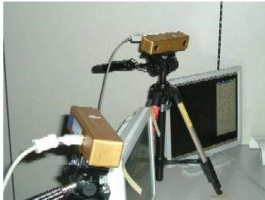
図 5.3 多眼式カメラの設置状況
