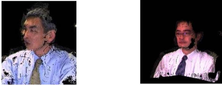
図 3.6 ステレオマッチング法により生成された画像の例
