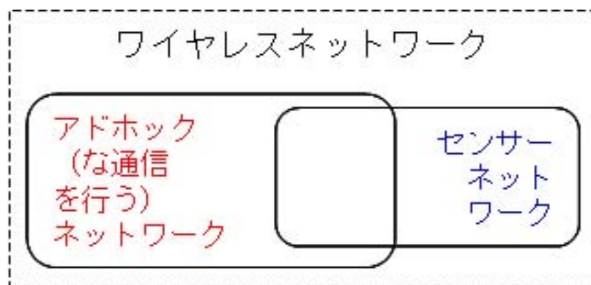
図 2.2: ワイヤレスセンサーネットワークとアドホックネットワークの関係
