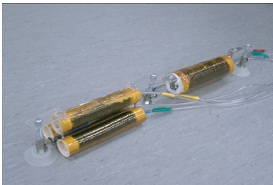
図 5.5: 並列接続による能動的方向転換機能を付加したミミズ型移動ロボット
