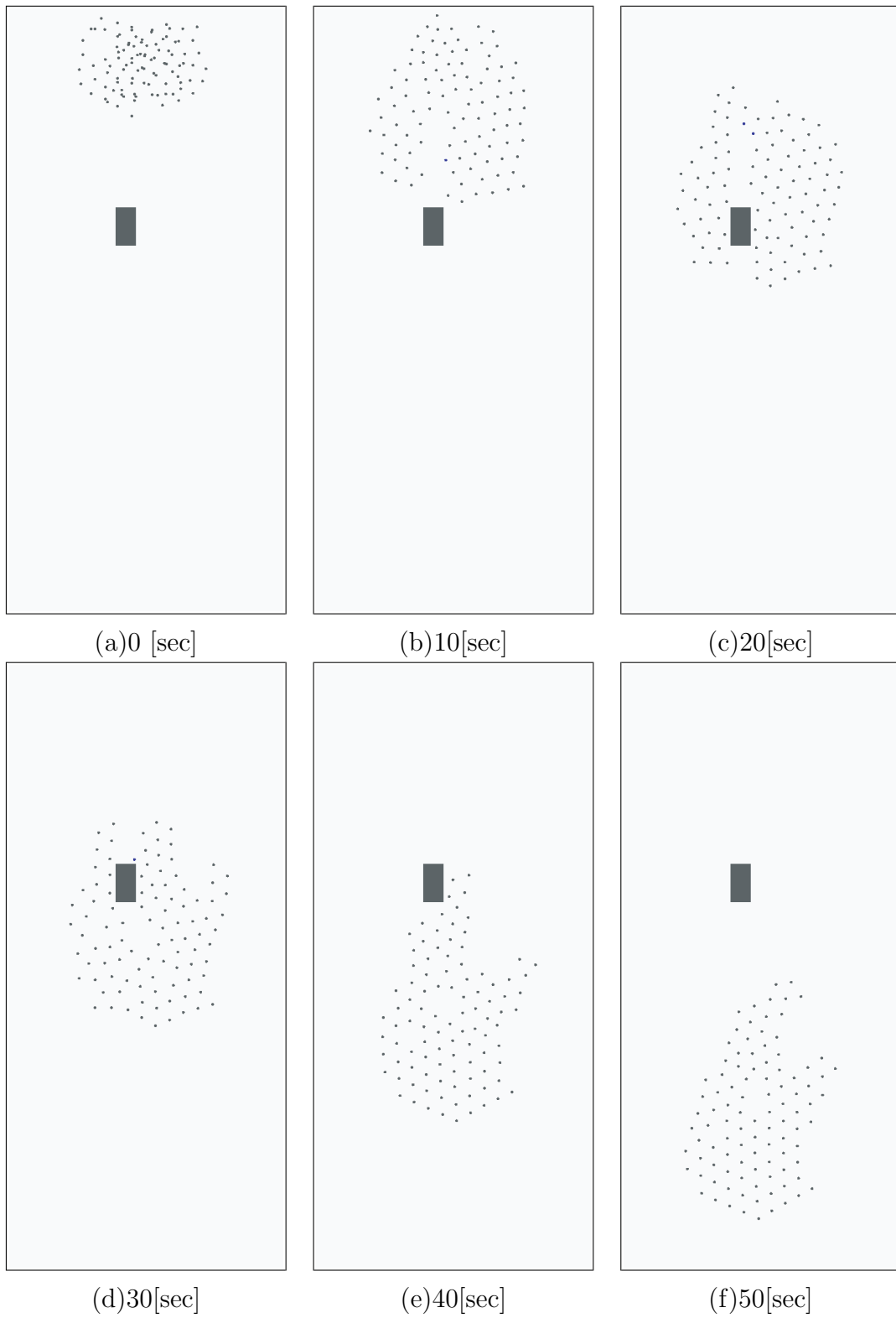
図 5.4: 単純な障害物の回避群移動
