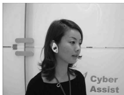
写真3-1 超小型軽量無電源携帯端末のプロトタイプの一例「イヤホン型 CoBIT」(2003; 資料3より)
