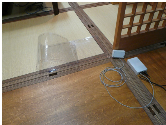
図7 量産型アンテナシートとアンテナ調整回路、リーダ装置
