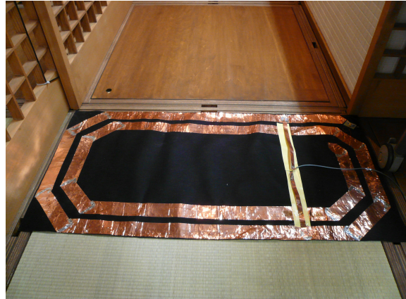
図1 アンテナシート (初期プロトタイプ。銅箔テープを用いて作成)
