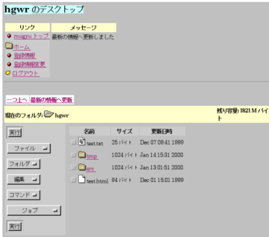
図 5.4: mugyu システムへのデスクトップページ画面。左下のメニューバーを開くと、利用できる操作がメニュー一覧となって表示される。右したには現在のディレクトリに存在するファイルおよびサブディレクトリが表示される。それぞれのファイルおよびディレクトリは、ボタンによって選択可能になっている。
