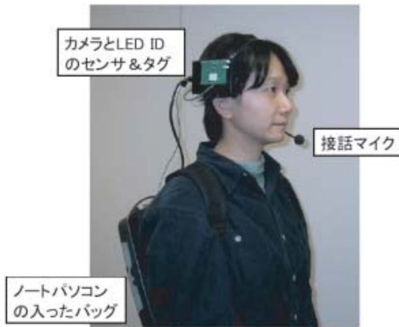
図 4.4: センサ類と記録用クライアントのセット
