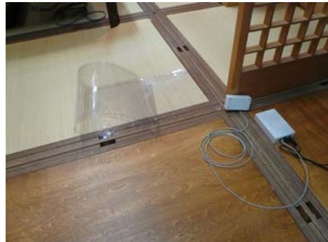
図 6 RFID アンテナとリーダ装置
