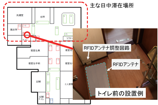
図11 アンテナの設置状況
