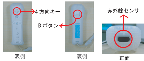
図 6: Wii リモコンと本システムでの利用部分
