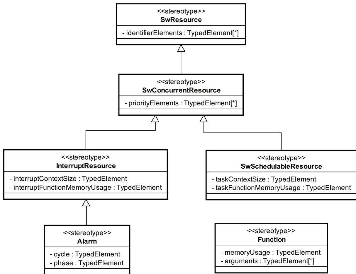
図 4.4: タスク設計モデルのメタモデル (タスク, 割り込み, 関数関連部分)
