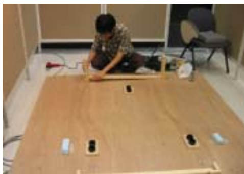
図3 筐体の製作過程 板上に黒く見える3箇所はエアプロウの吐出口
