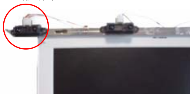
図2 赤外線測距センサの設置
