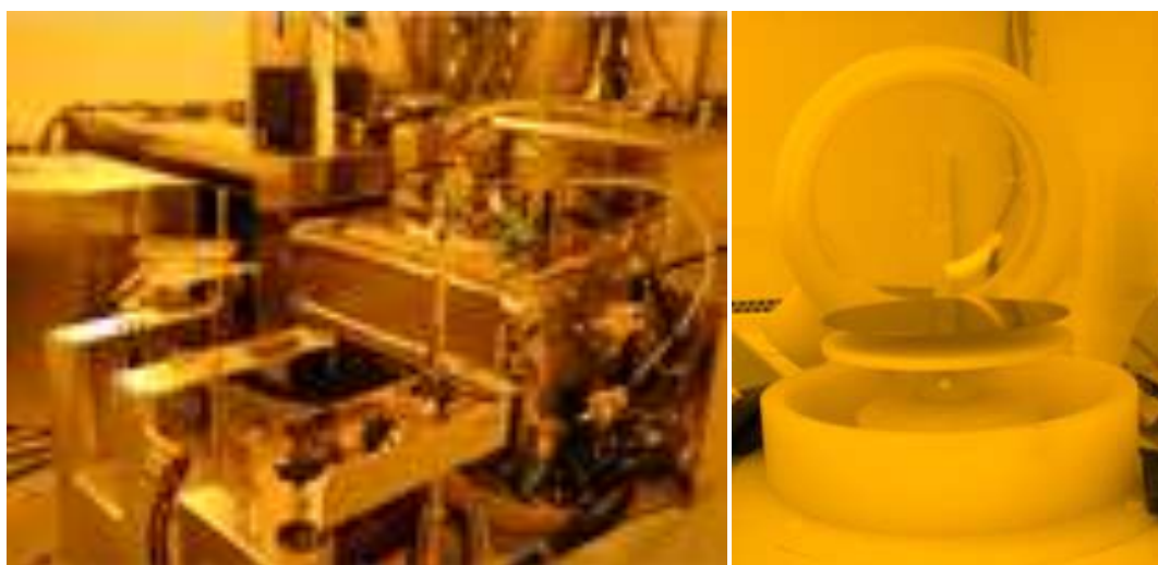
【図 5-6】半導体素子製造におけるフォトリソグラフィー [凸版印刷] (左) ウェハにレジストを塗布するためのスピナー 12 (右)
