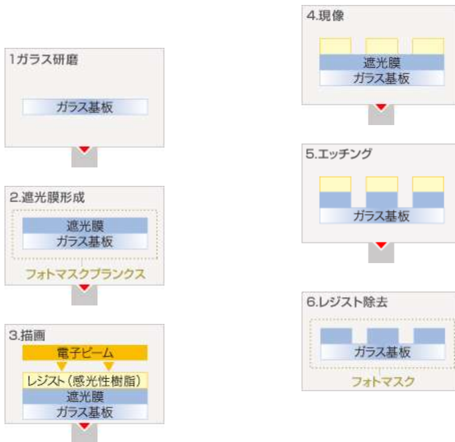
【図 5-7】 LSI などの半導体とフォトマスクの製造工程 [凸版印刷] 17
