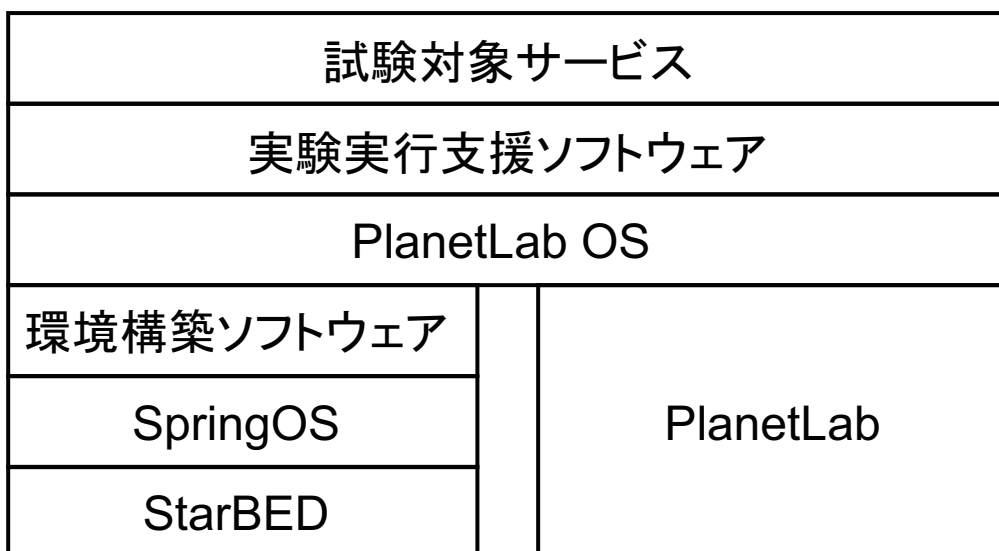
図 5.1: StarBED と PlanetLab による構成
