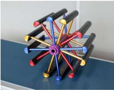
独自に開発したリムレスホイールを用いて、歩行の安定性や最適性を探求している。
