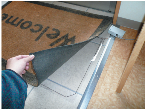
図 5 RFID アンテナ（銅線部分）とリーダ装置 Fig. 5 RFID Antenna and reader.
