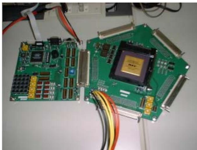
図 3.10: 使用した FPGA ボード
