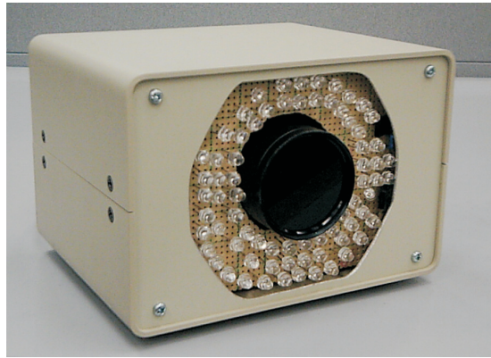
図 5.3: 近赤外投光 LED アレイを有するインテリジェントビジョンカメラ
