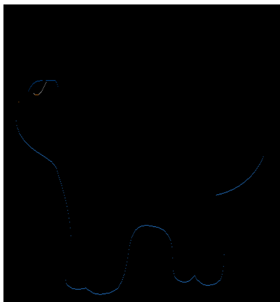
(b) (a)に下方方向の微分フィルタをかけた例
