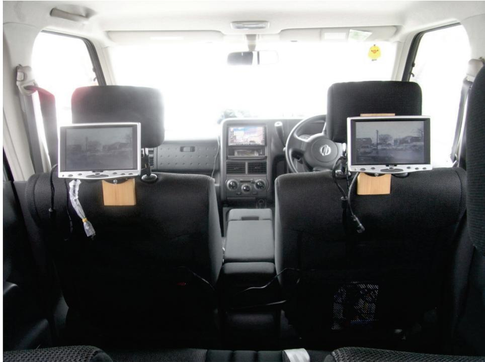
図 4.3 車内に後席ディスプレイを設置した様子
