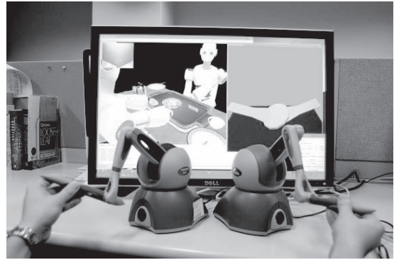
図 2 SIGVerse を用いたユーザとロボットの協調
